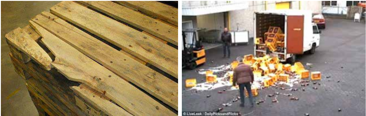
Figura 8 – Esempi di rottura di un'asse del piano superiore di un pallet e di danneggiamento dei colli di merce durante attività di scarico di un mezzo
