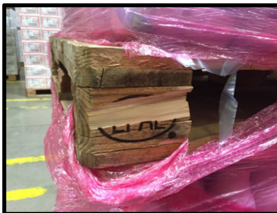
Figura 4 - Blocchetto scheggiato e rovinato sul lato esterno.
