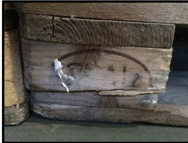
Figura 6 - Il marchio EPAL risulta poco visibile e determina la non idoneità del pallet EPAL.
