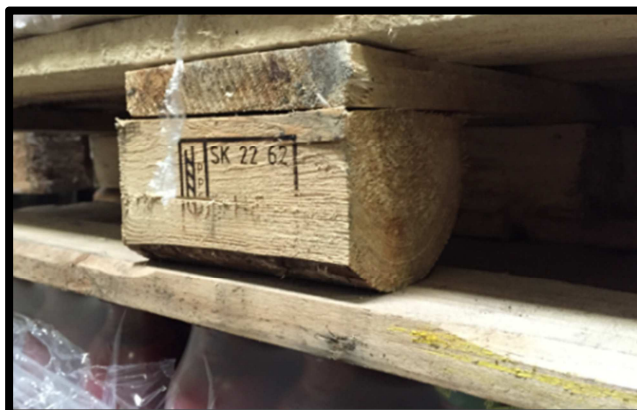
Figura 7 - Il blocchetto centrale mostra difettosità di produzione, poiché il marchio IPPC risulta essere originale, anche se sbiadito
