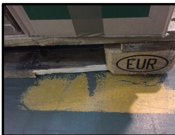
Figura 3 - Tavola inferiore del pallet rovinata, che influenza la capacità di carico statico del bancale stesso.
