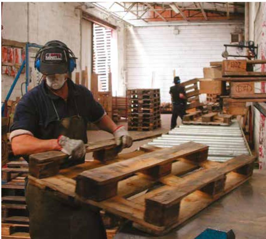
diventando sempre più importante: recente è la decisione di EPAL di concedere la riparazione di pallet di classe C con elementi usati. L'automazione oggi consente di selezionare e ridimensionare traverse e tavole usate di dimensioni differenti scansionando lunghezza, altezza e spessore, di provvedere a tagli automatici degli elementi usati e di ordinarli per dimensioni, pronti all'uso.
