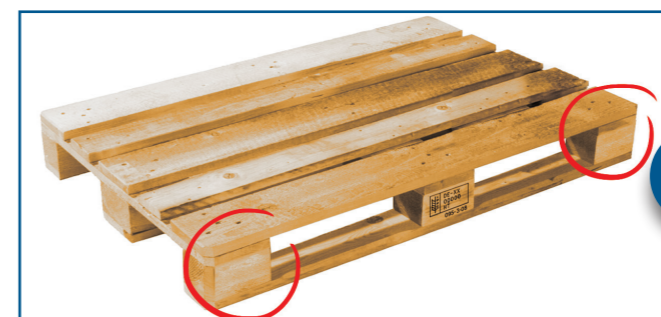
Manca il marchio EPAL sui blocchetti laterali (se è un pallet prodotto dopo il 1 Agosto 2013); manca il marchio EUR a destra e EPAL a sinistra (se è un pallet prodotto prima del 1 Agosto 2013)
