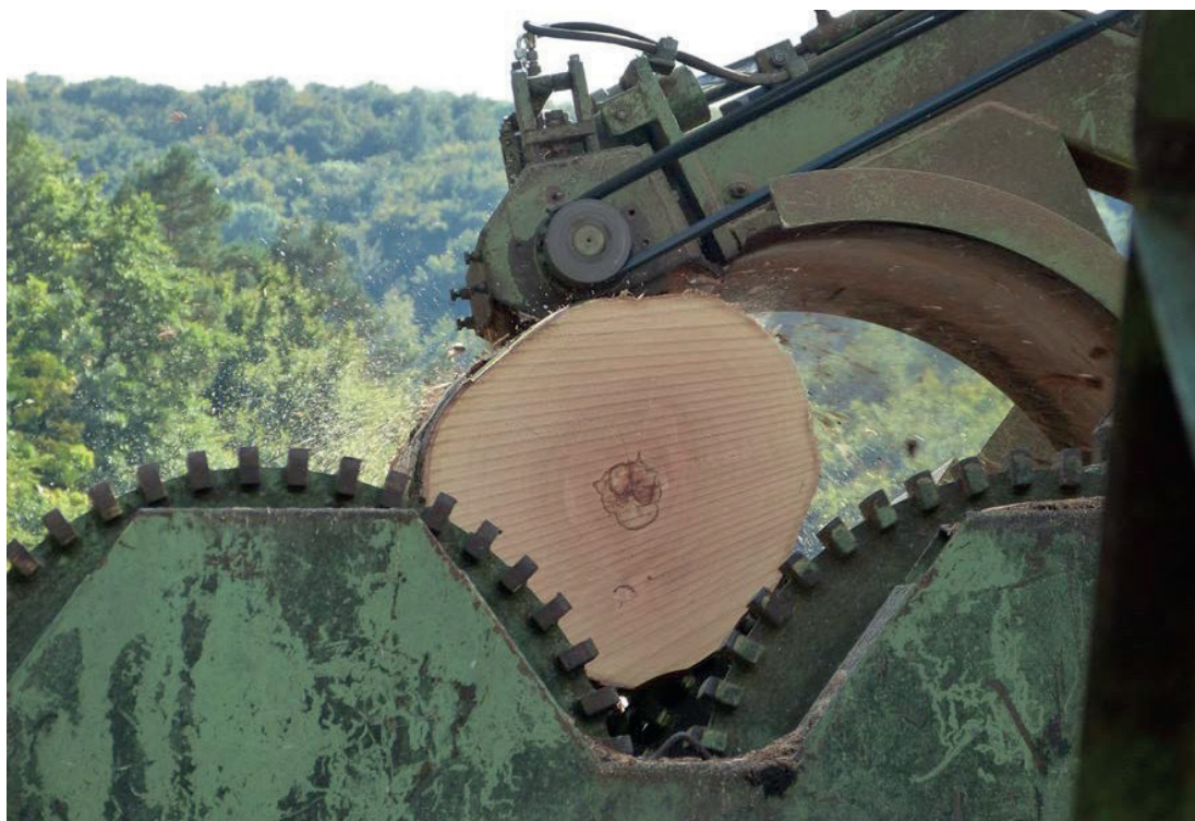
Figura 2: Attrezzatura per lo scortecciamento di tronchi di legno di latifoglie
