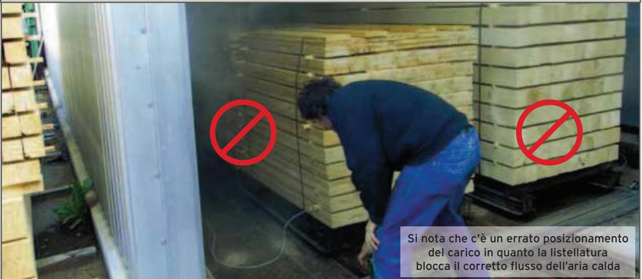
Si nota che c'è un errato posizionamento del carico in quanto la listellatura blocca il corretto flusso dell'aria calda
