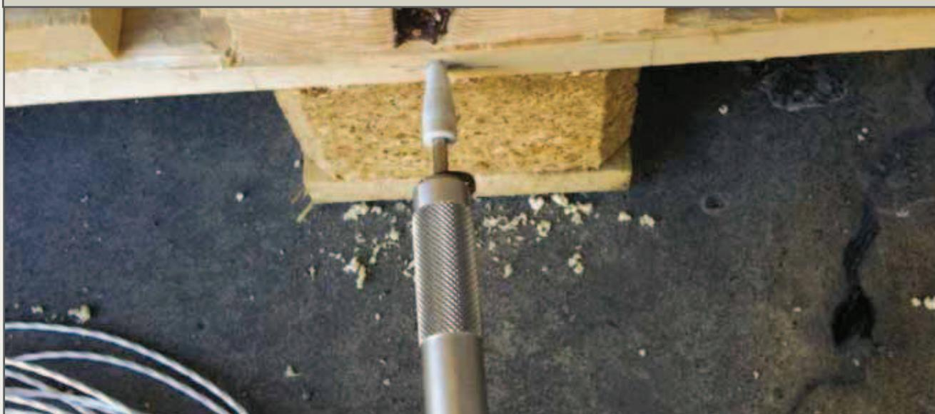
SONDA DI PROCESSO INSERITA SU PALLET CON BLOCCHETTO DI LEGNO MASSICCIO
