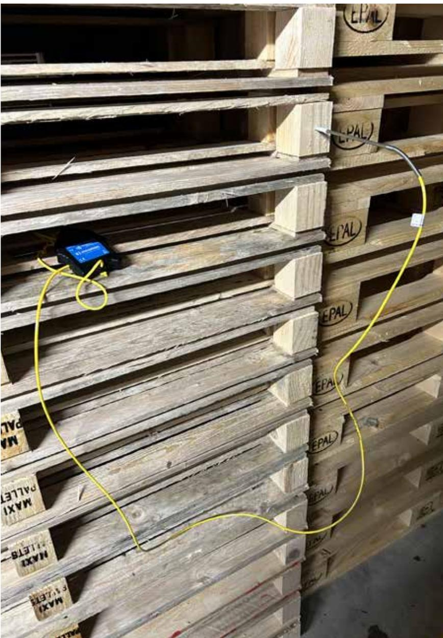
Il sistema wireless di Logica H&S, predisposto da INCOMAC all'interno di questo impianto, si compone di sonde certificate ciascuna collegata tramite un cavo da 2 m ad un trasmettitore (LG36 MoistureMouse) che invia il segnale direttamente ad unità ricevente dotata di antenna.
