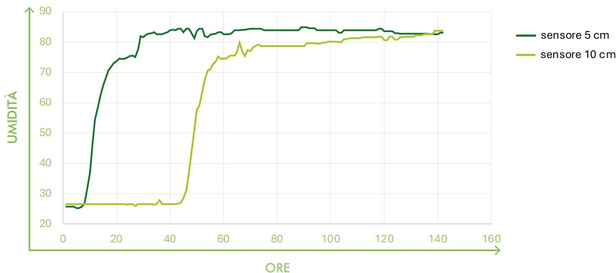
Il sistema sviluppato permette inoltre di stimare l'andamento dell'umidità del massetto nel tempo, fornendo anche indicazione dello stato di asciugatura del massetto stesso, diventando utile anche nel caso di interventi di ripristino. Dai test effettuati, in funzione del periodo dell'anno, i massetti hanno impiegato dai 3 ai 3,5 mesi per asciugarsi completamente nella configurazione dei test (assenza di membrane o isolanti).
