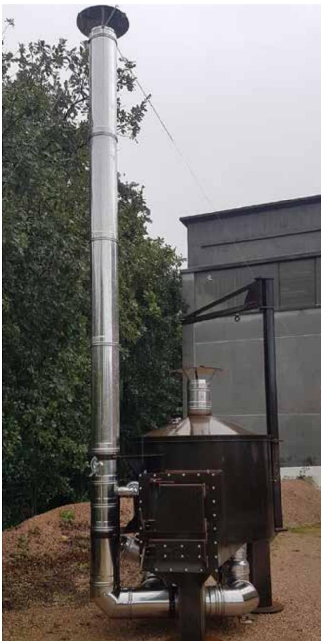
Il materiale è stato carbonizzato con un prototipo di forno di carbonizzazione indiretto, con temperature fino a 480° C.
