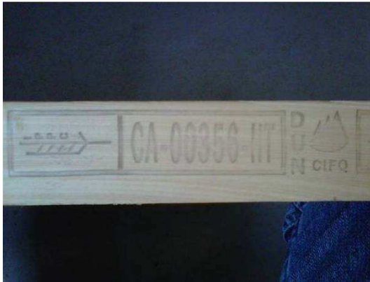
Figura 1 5 – Il marchio corrisponde all'esempio 6 riportato nell'Allegato 2 dell'ISPM 15:2009. Informazioni aggiuntive esterne alle linee di demarcazione del marchio
