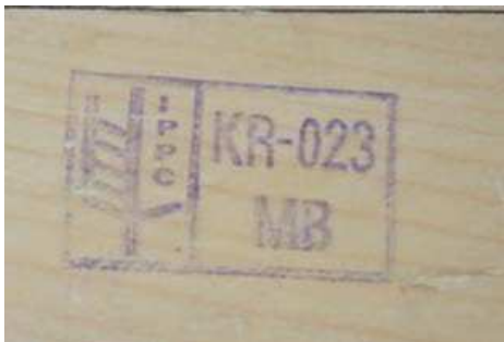
Figura 3 6 – Il marchio corrisponde all'esempio 1 riportato nell'Allegato 2 dell'ISPM 15:2009.
