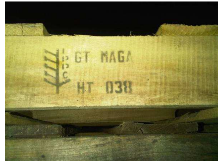
Figura 4 6 – Il marchio è privo delle linee di demarcazione richieste.
