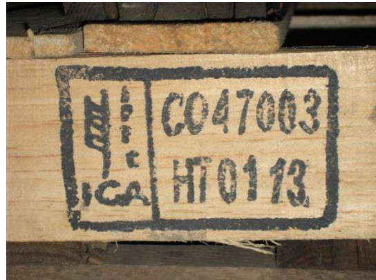
Figura 2 6 – Informazioni non conformi a quanto disposto nell'Allegato 2 dell'ISPM 15:2009 contenute all'interno delle linee di demarcazione del marchio
