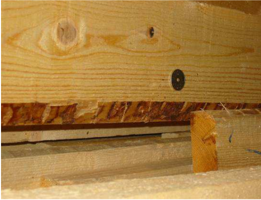
Figura 1 – Lo smusso di piallatura sul bordo del tavolame non è regolare se superiore ai 3 cm.
