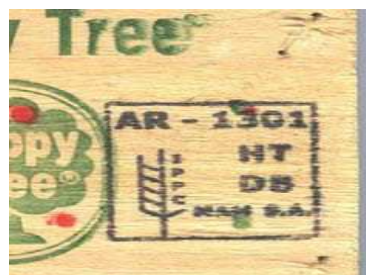
Figura 5 6 – L'orientamento delle informazioni non corrisponde agli esempi riportati nell'Allegato 2 dell'ISPM 15:2009. La quantità di informazioni contenute entro le linee di demarcazione del marchio supera quanto previsto dai requisiti.
