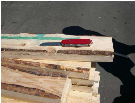
Figura 3 – Corteccia sul bordo della tavola. Il coltello misura 2 cm per 15, pertanto la tavola è conforme alle tolleranze ammesse. La tavola sottostante a quella con il coltello presenta solo smussi (cambio scolorito), pertanto è conforme.
