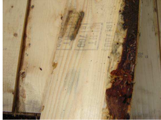
Figura 2 – La presenza di corteccia sul bordo della tavola è inferiore a 3 cm, pertanto la tavola è conforme ai requisiti di tolleranza previsti per la presenza di corteccia sul legno.
