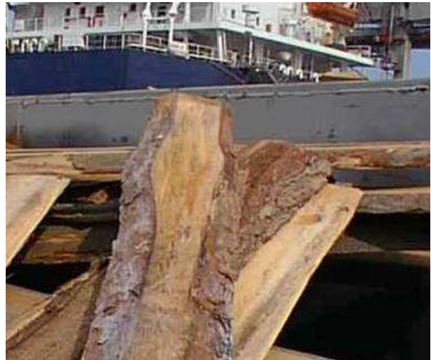
Figura 6 – La corteccia supera i valori di tolleranza. Il pagliolo imbarcato non è conforme.
