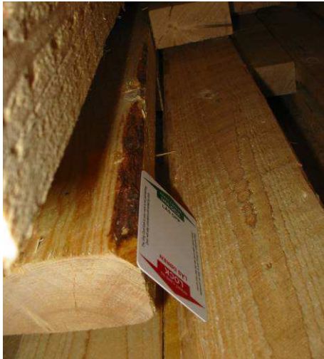
Figura 5 – La corteccia sul bordo ha una larghezza superiore a 3 cm ed è complessivamente superiore a 50 cm 2 . La corteccia deve essere rimossa, diversamente il pezzo non può essere utilizzato come materiale da imballaggio in legno.
