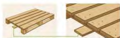
2. Manca un blocchetto o è danneggiato.
