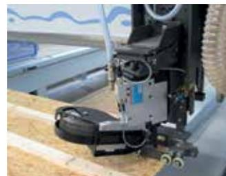
Sistemi automatici di chiodatura per la realizzazione di elementi per la costruzione di case in legno.
