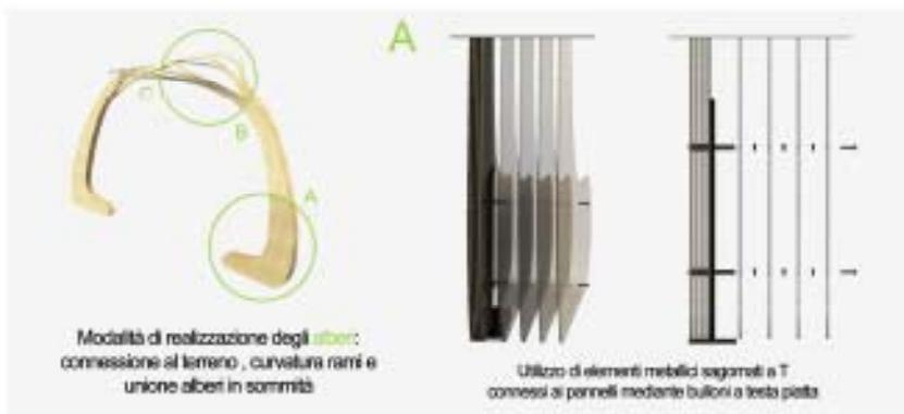
Alberi: processo di curvatura dei rami e connessione tra due componenti
